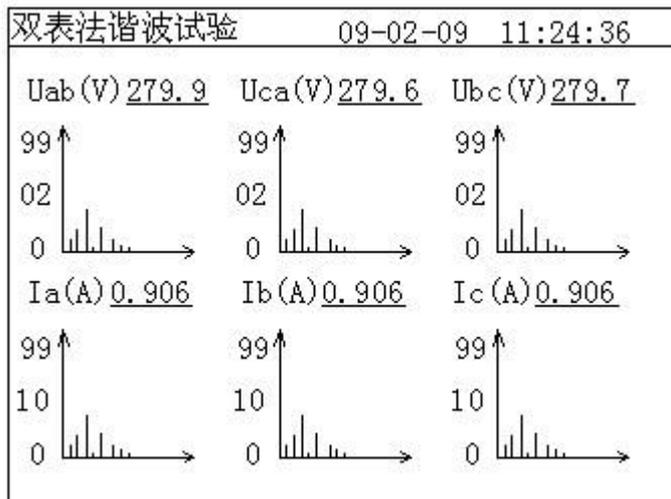
图 15 谐波分量频谱图页面
