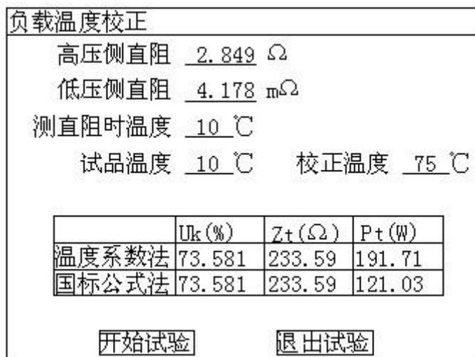
图 13 负载结果温度校正页面
